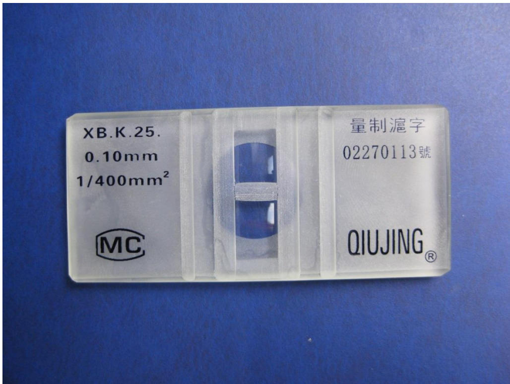
Imagen 6 – Porta muestras con cámara de Neubauer
